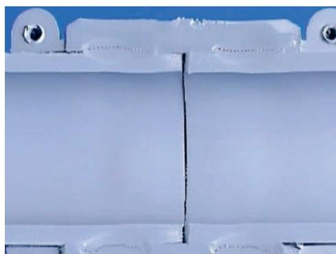
Место сварки имеет толщину материала превышающую толщину стенки трубы
